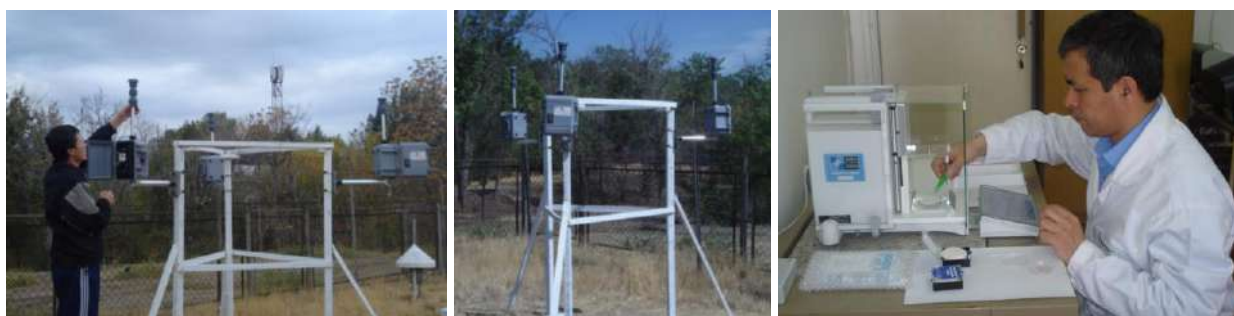
Рис. 1. Пробоотборники воздуха, установленные на метеоплощадке Ташкент-Обсерватория и процесс взвешивания фильтров
