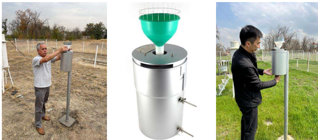
1-расм. Тошкент-Обсерватория метеорология станциясига ўрнатилган PALMEX ёғин йиғгичи
