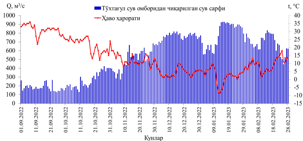
5-расм. Тўхтағул сув омбори тўғонидан қуйи бьефга ташланган сув сарфлари (Q) билан ҳаво ҳарорати (t) нинг ўзгаришлари (2022-2023 йй. куз-қиш мавсуми)
