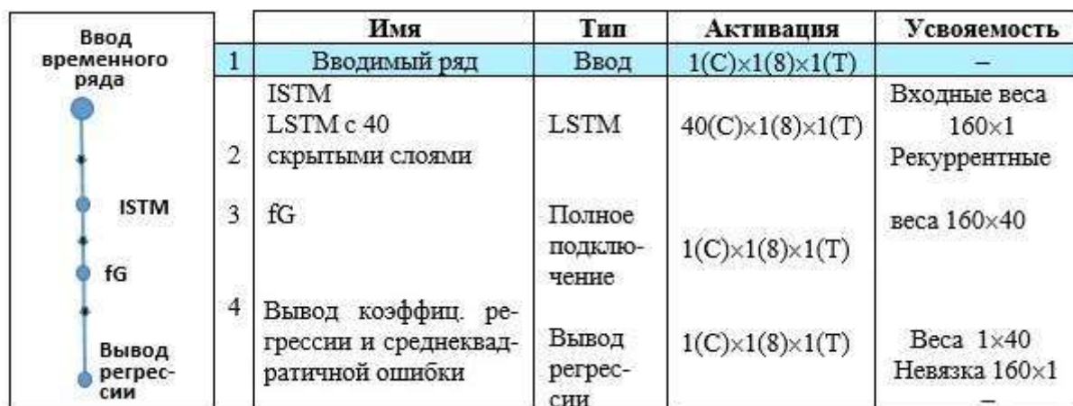
Рис. 3. Визуализация сетевой архитектуры модели LSTM
