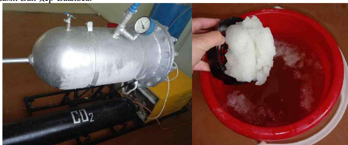
а) Экспериментально-модельная установка деминерализации вод; б) Образец полученного гидрата
