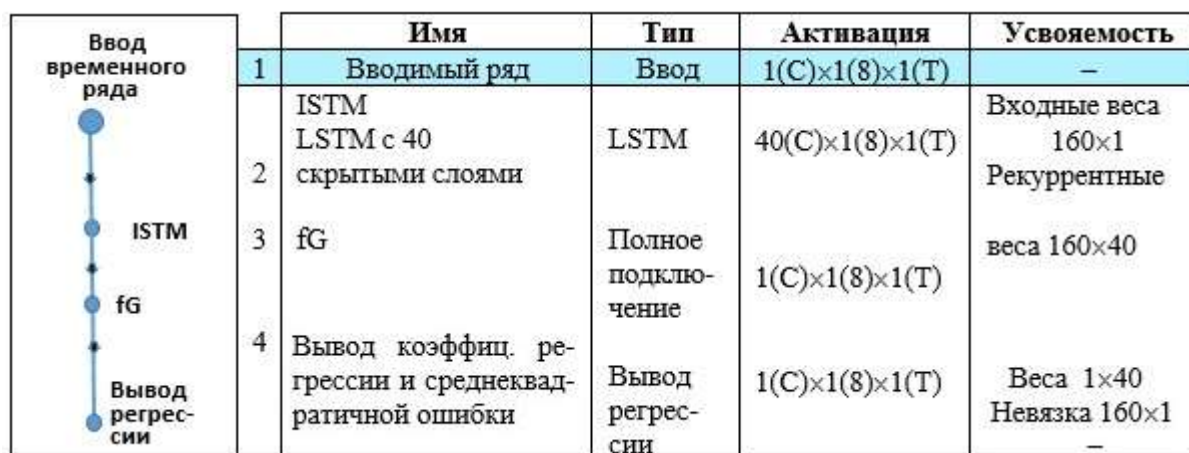
Рис. 3. Визуализация сетевой архитектуры модели LSTM
