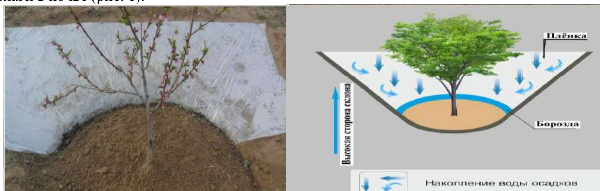
Рис. 1. Схема увеличения площади накопления осадков покрытием плёнкой
