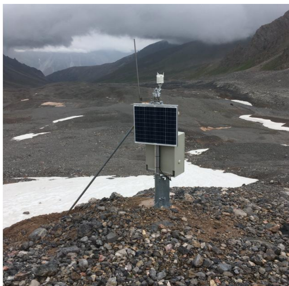
Рис. 12. Автоматическая метеостанция на леднике Баркрак Средний
